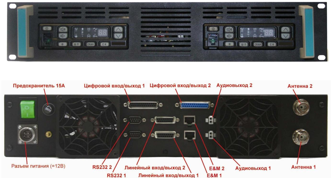
Рисунок А.2- Внешний вид радиостанции. Вариант комплектации №3, для ретранслятора или дуплексного режима работы
