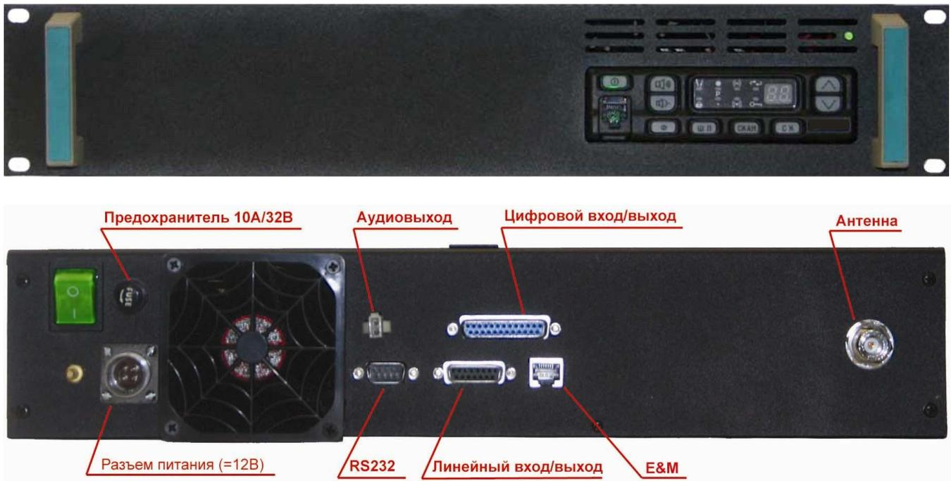
Рисунок А.1- Внешний вид радиостанции. Варианты комплектации №3
